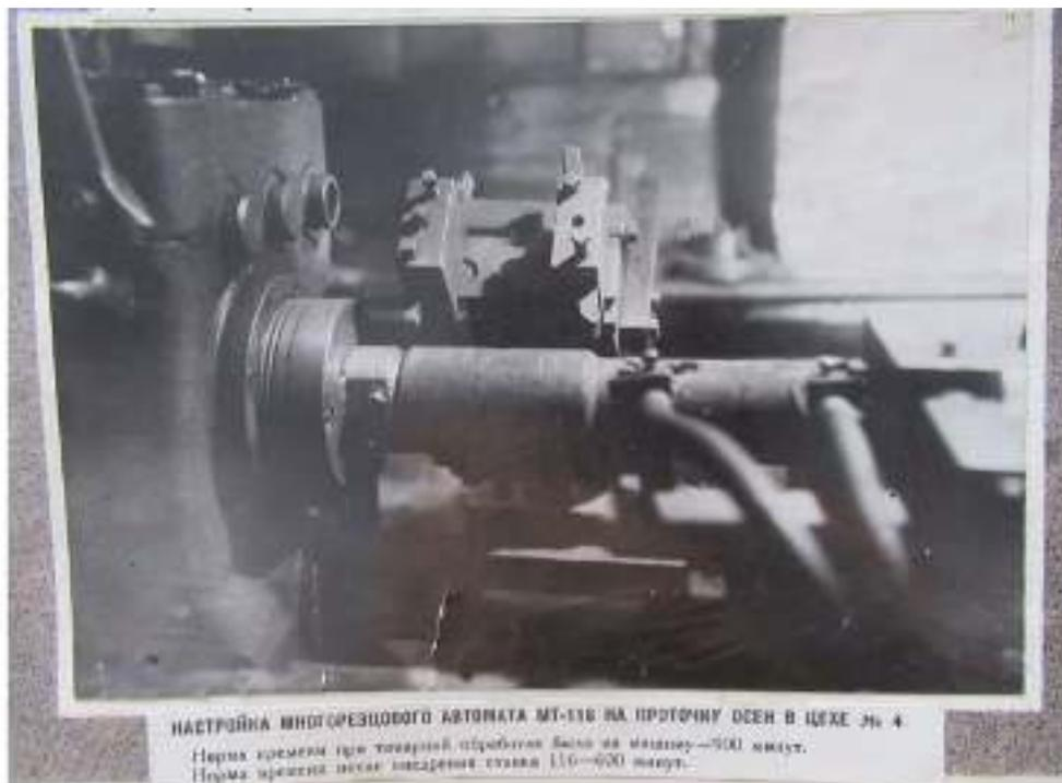
**НАСТРОЙКА ВИНОГРЕЗОВОГО АВТОМАТА МТ-110 НА ПРОТОЧКУ ОСЕЙ В ЦЕХЕ № 4.**
